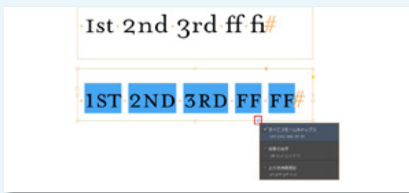
① OpenType機能の強化 テキストフレームの下部に「O」のアイコンが発生し、アイコンをクリックするとOpenType機能のウィンドウが表示される。 欧文だけでなく和文であっても、対応しているフォントならば使用可能。
