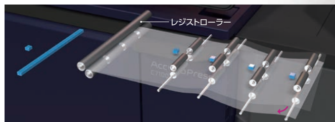
1 レジストローラーに突き当てることで用紙の曲がりを補正
